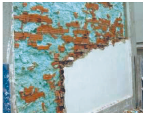
Comprobación en laboratorio del completo llenado de la cámara.
