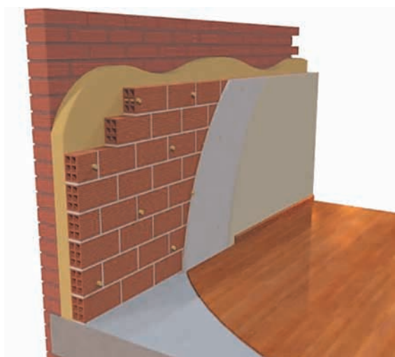
Inyección de poliuretano por el interior.
