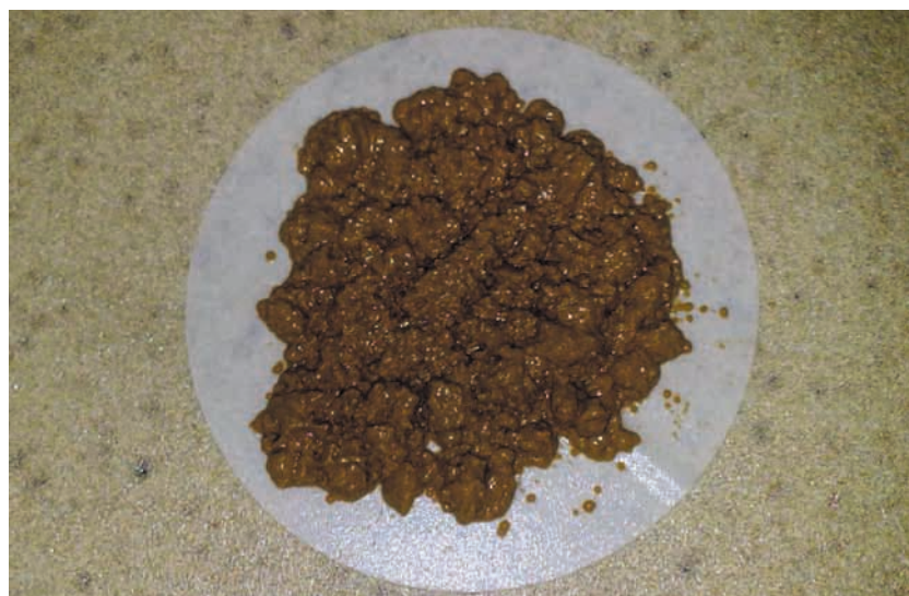
Figura 13. Ensayo de absorción de agua de la bentonita.
