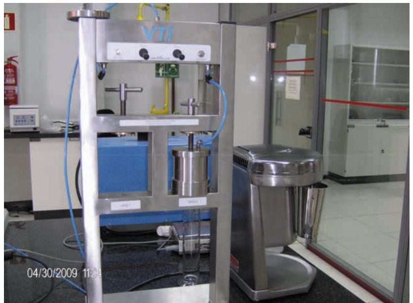
Figura 15. Equipo utilizado para el ensayo de pérdida por filtrado de la bentonita.
